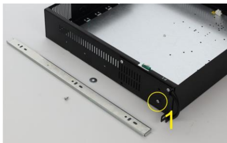
Odkręć pierwszą śrubę M4 z obudowy ARAD
