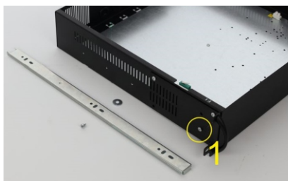
Odkręć pierwszą śrubę M4 z obudowy ARAD
